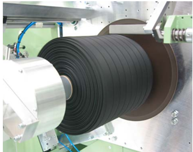
在 UV60-RS 上带芯卷绕，宽 350 毫米，直径 400 毫米
