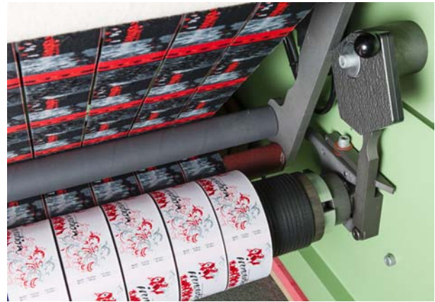
Sistema enrollador de cintas de la MBJL6 para alta versatilidad en cambios de artículos
