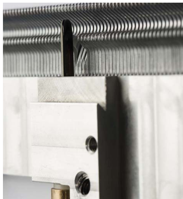
Canal de aire con toberas auxiliares
