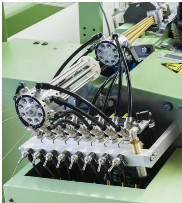
Azami 8 renk atkı ipliği için atkı besleme sistemi
