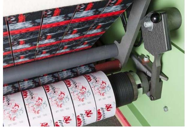
MBJL6 Ürün değişiminde esneklik sağlayan bant sarım sistemi
