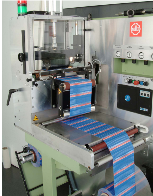
Zuführung des Etikettenbandes ab Vorlagerolle
