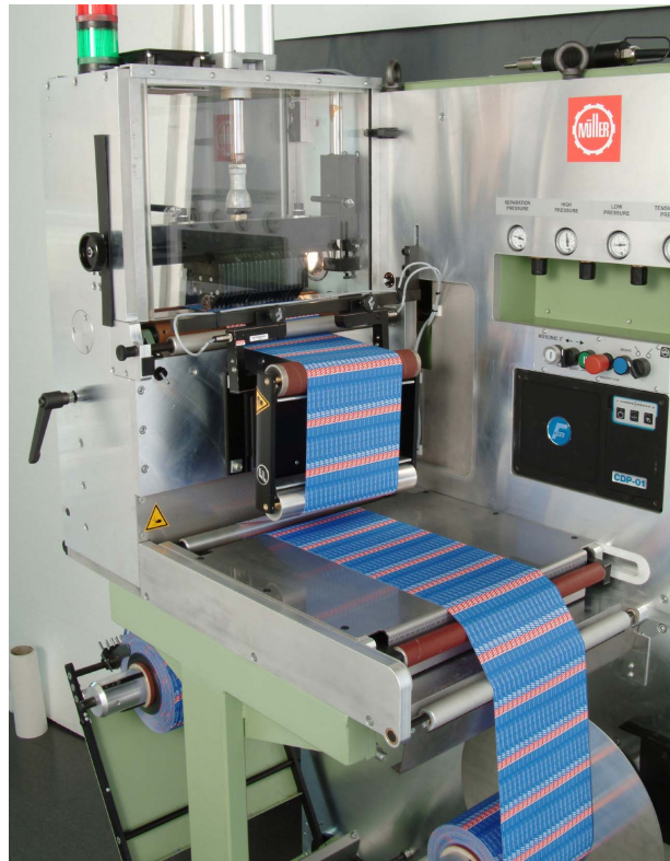
Alimentación de la cinta de etiquetas desde rollo
