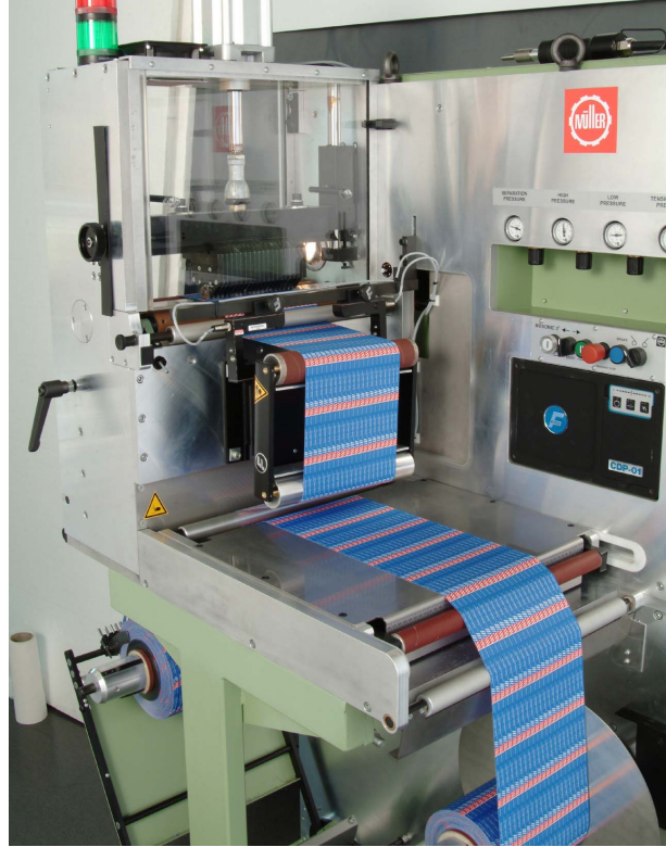
Besleme rulosundan etiket bandının makineye beslenmesi
