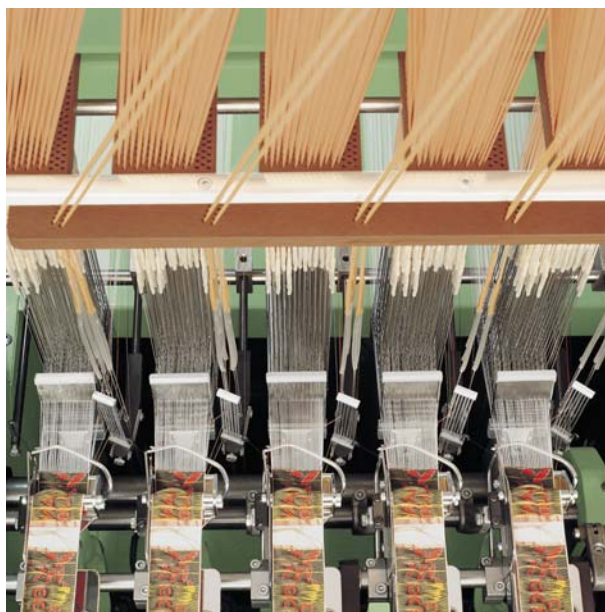
Détail du harnais avec sélection des fils, poste de tissage
