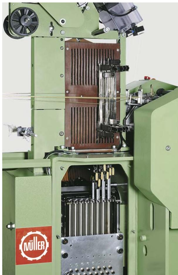
Accionamiento (patentado) de los cuadros de lizos con movimiento controlado por suspensión neumática
