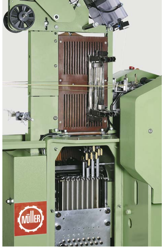
Hava basıncı ile ayarlanan patentli çerçeve tahriki
