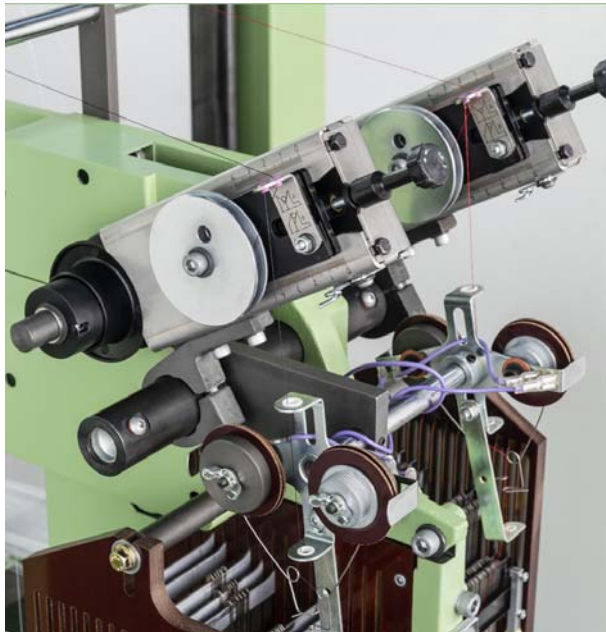
Tel yay kompensasyonlu atkı besleme seçeneği
