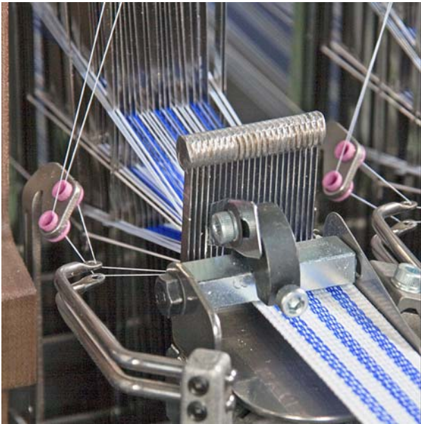
具有投纬针和辅助导纱器的双针 Z- 系统
