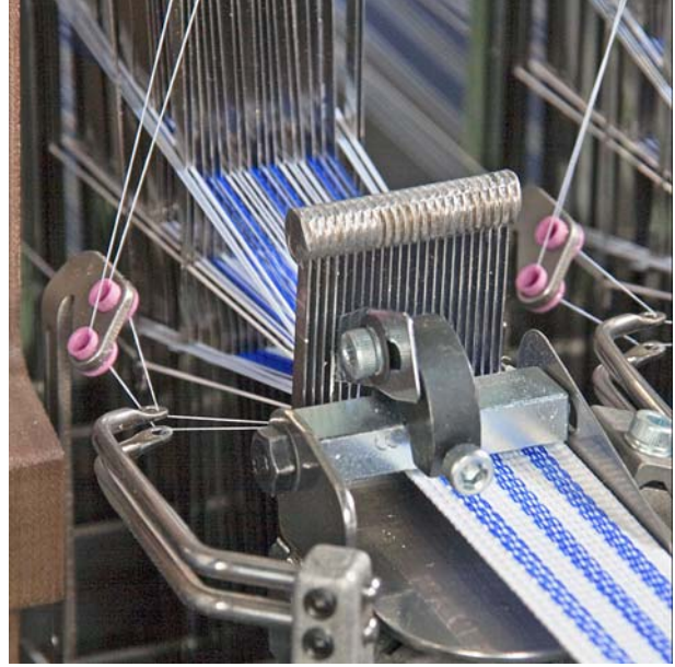
Atkı besleme mekiği ve yardımcı iplik kılavuzu ile 2 atkı mekikli Z-sistem alanı.
