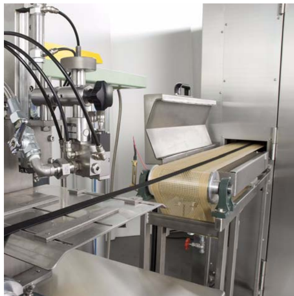
Essiccatoio orizzontale dopo il vaporizzatore ristretto
