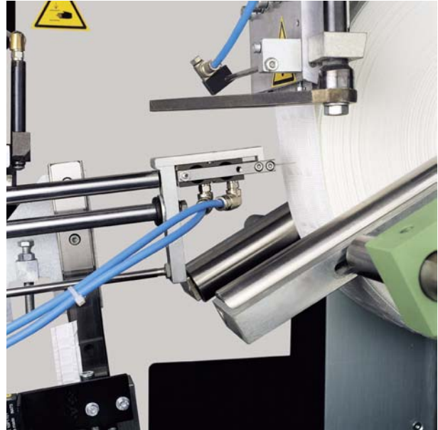
RAM-500 可选配置：条带末端固定的订针装置
