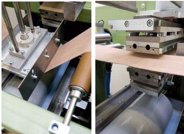
SU200 zum Aufbringen eines Silikonstreifens für die Endenversiegelung der Schnittkanten
