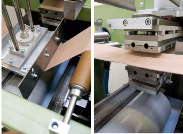
SU200 kesilen kenarların sabitlenmesi için silikon şerit uygulama tertibatı
