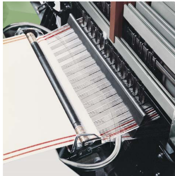
Schusseintragssystem mit einem Schussnadelpaar
