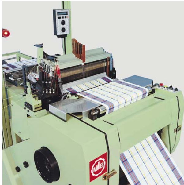
NCE para cintas anchas y toallas de mano de hasta 340 mm
