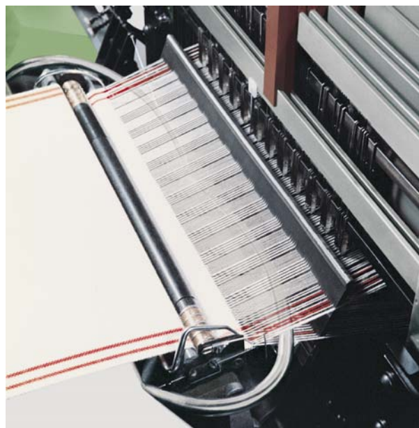
Sistema di inserzione trama con una coppia di falcette tramatore
