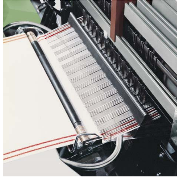
Bir çift atkı iğnesi ile donatılmış atkı besleme sistemi
