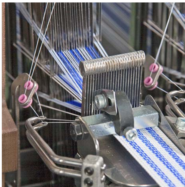
Doppio ago con spazio "sistema-Z"; inserzione di trama con guidafili ausiliario
