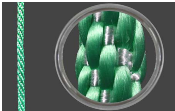
Muestra de cordón no elástico, de dos colores con \varnothing 6.0 mm
