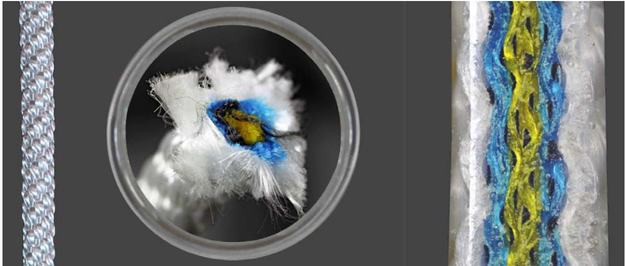
Cuerda con alma y recubrimiento con un diámetro de 11 mm; estructura exterior (izquierda). Foto detallada alma-recubrimiento (centro); estructura interna (derecha)
