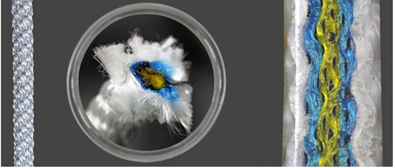
Çekirdek-manto dan oluşan ipliğin çapı 11mm, dış görünüm (sol), detay kesit (orta)
