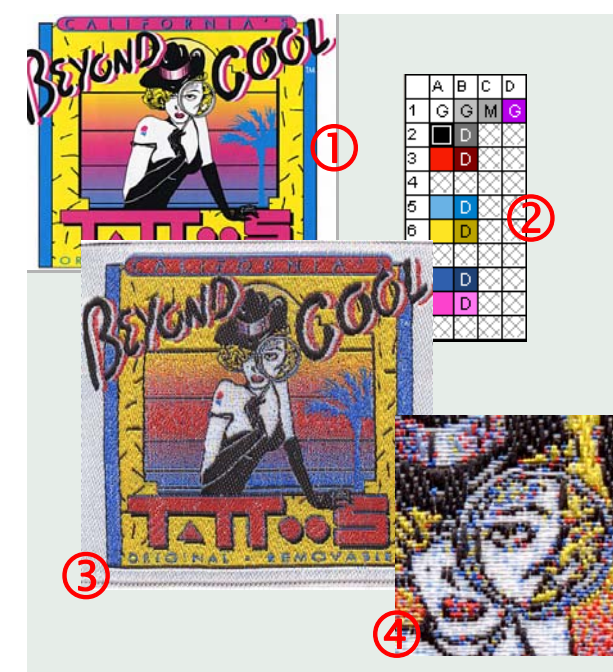
Il modello, ad esempio una immagine o una fotografia (1), viene innanzitutto digitalizzata e analizzata a partire da informazioni di colore fino al dettaglio, tali informazioni vengono poi attribuite ad una gamma di 7 colori massimo (2) e definita infine come disegno di tessitura. L'etichetta tessuta (3), con una larghezza di 50 mm e (4) il dettaglio ingrandito (della stessa)
