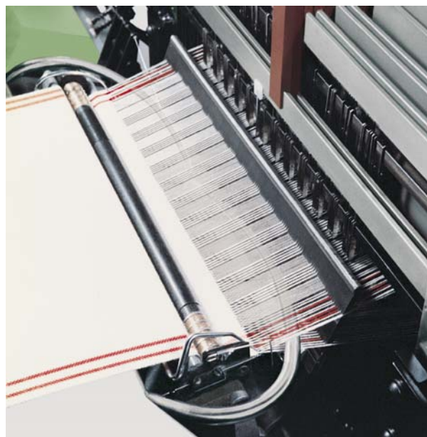
Système de trame avec une paire d'aiguilles de trames
