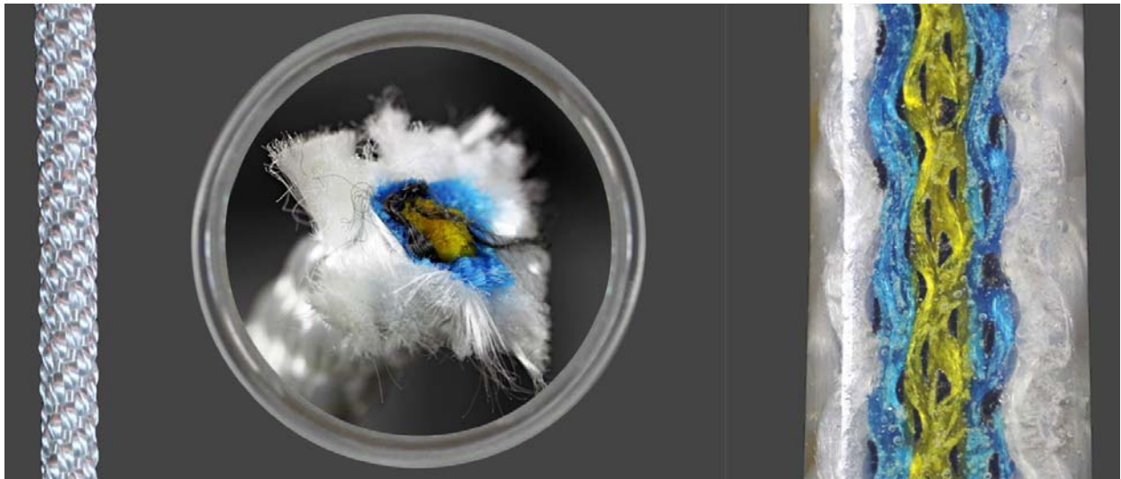
直径为 11 毫米的纱芯护套绳，外部结构（左边），纱芯闭合（中心），内部结构（右边）
