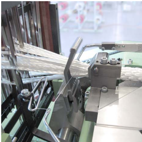
NC2M 织造头 用于精确织物导向的托架（专利）
